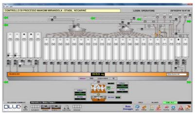
Per garantire continuità nelle operazioni durante le fasi di revamping, sono stati replicati tutti i nodi di I/O già in essere e rimpiazzati da schede I/O Versapoint di GE: in tal modo è stato facile rimuovere le vecchie isole remote e ricollegare gli I/O al sistema di GE su rete Profibus, senza interrompere la produzione dello stabilimento.
